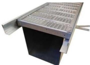
**Caniveaux** : Ils assurent une ventilation optimale mais sont prévus pour des stockages moyens. Comme ils sont enterrés, ils posent moins de problèmes de manutention. Le niveau des grilles doit cependant être légèrement en dessous du niveau de la dalle bétonnée pour que le godet n'accroche pas. Le coût à la construction est cependant assez élevé.
