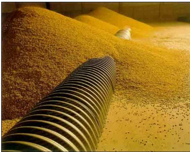
Gaines de ventilation céréales
