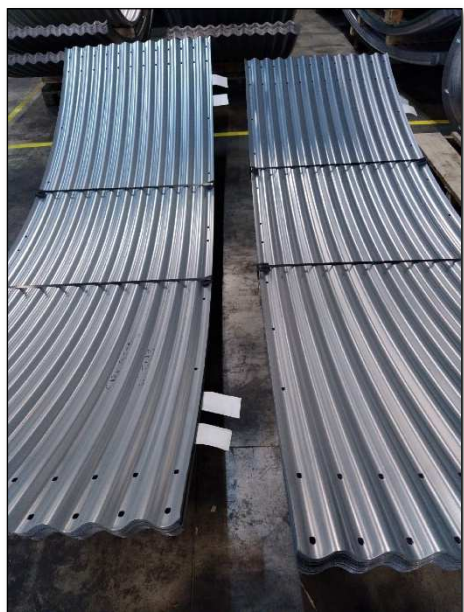
Tôles de réparation, de remplacement
