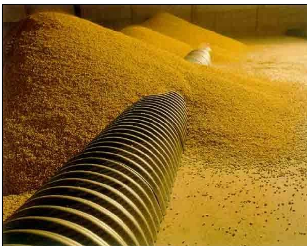
Gaines de ventilation céréales
